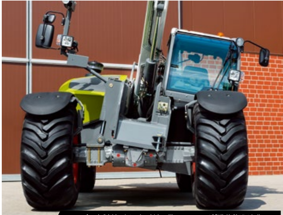
Az első híd szintezése hidraulikusan a vezetőfülkéből történik
