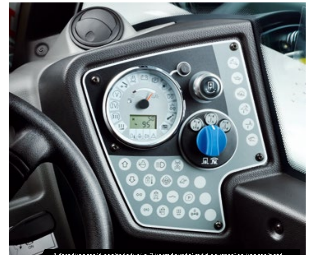
A forgókapcsoló segítségével a 3 kormányzási mód egyszerűen kapcsolható
