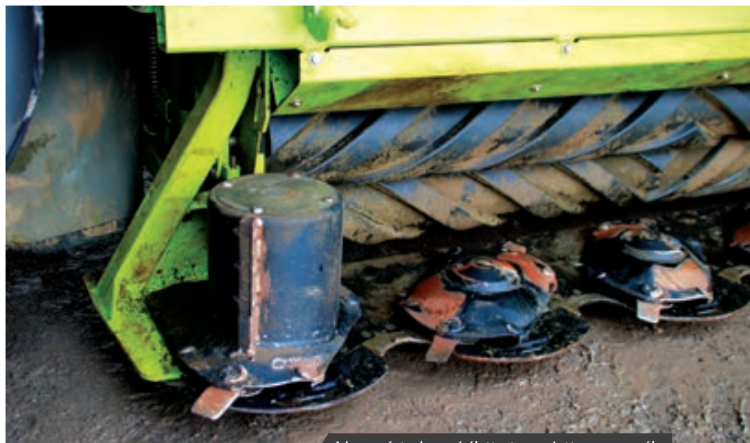
A kaszasínt a hosszú élettartam miatt csavarozzák
