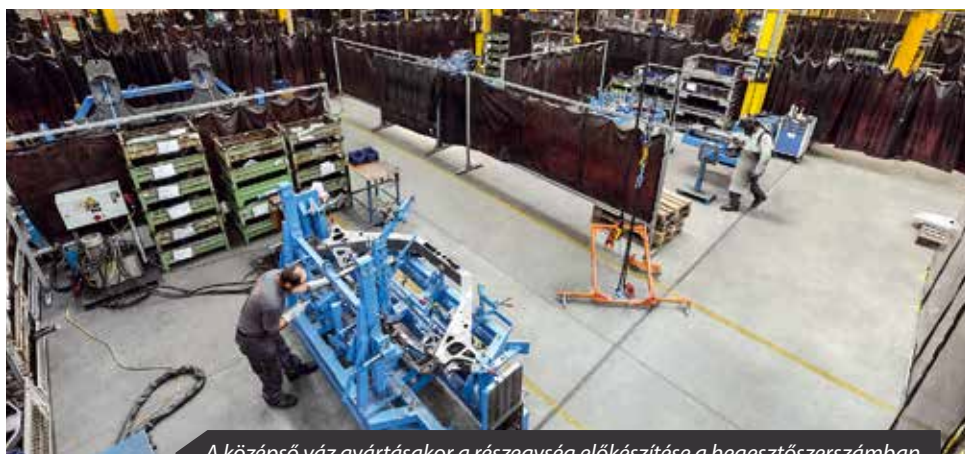
A középső váz gyártásakor a részegység előkészítése a hegesztőszerszámban.
