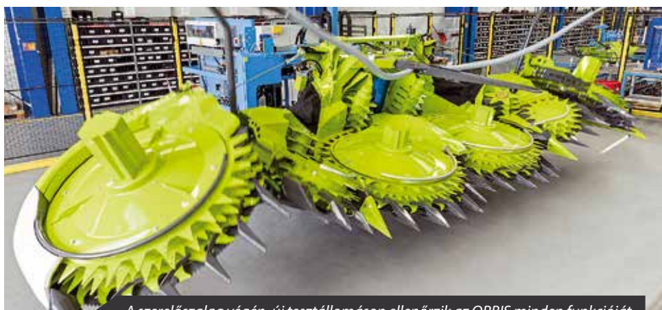
A szerelőszalag végén, új tesztállomáson ellenőrzik az ORBIS minden funkcióját.
