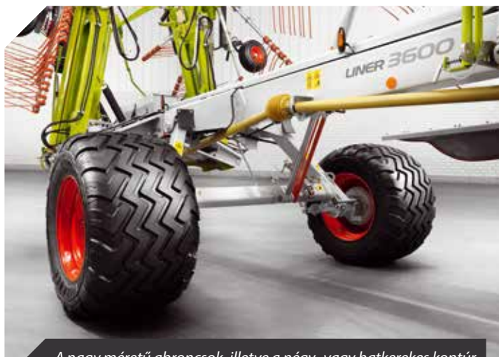
A nagy méretű abroncsok, illetve a négy- vagy hatkerekű kontúr futómű a talajt és a fűtakarót egyaránt védik.
