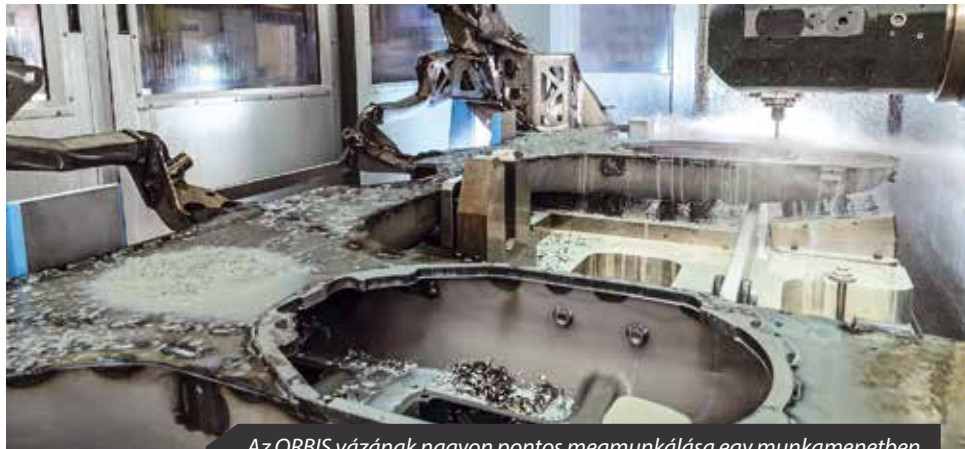
Az ORBIS vázának nagyon pontos megmunkálása egy munkamenetben.
