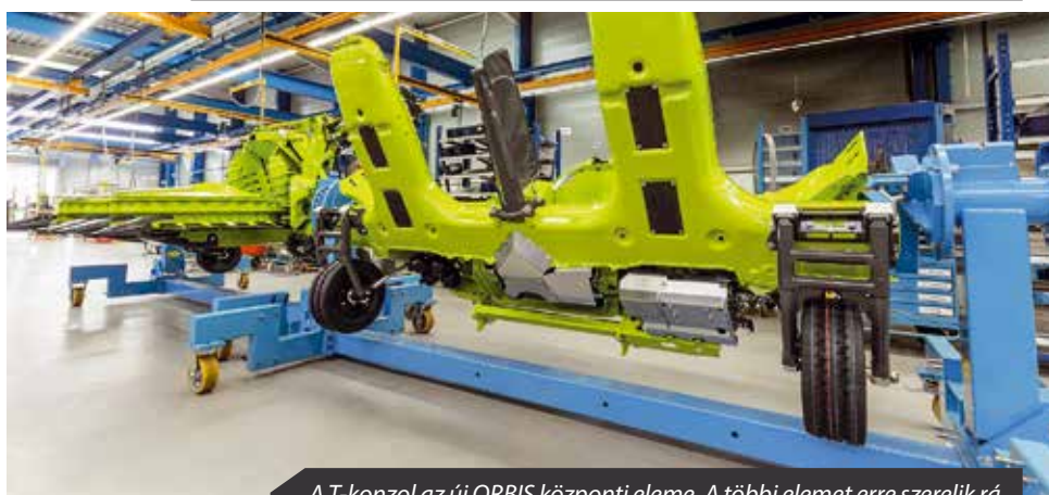
A T-konzol az új ORBIS központi eleme. A többi elemet erre szerelik rá.
