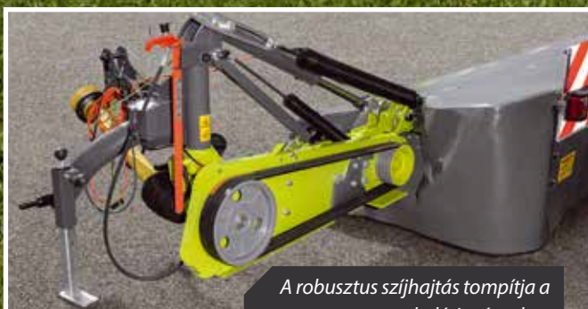
Az oldalsó felfüggesztés nagy dőlésszöveget tesz lehetővé lejtőn le- vagy felfelé.
