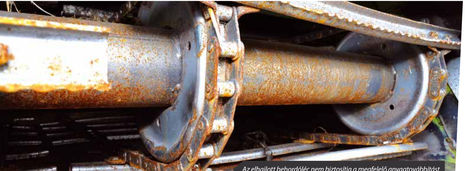
Az elhajlott behordóléc nem biztosítja a megfelelő anyagvábbitást
