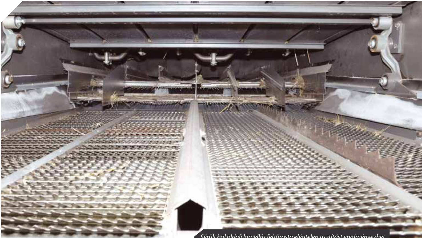
Sérült bal oldali lamellás felsőrosta elégtelen tisztítást eredményezhet
